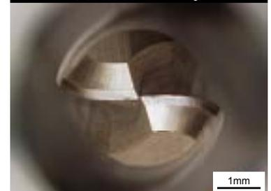
**EHHBE-TH3で高能率側面切削をすることで、従来2枚刃ボールエンドミルよりも高能率・長寿命に加工できます。**
