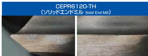
被削材 Work material : SCM435(27HRC) 工具径 Tool dia. :  $\phi 12$  使用機械 Machine : HSK-A63 切削長 Cutting length : L=27m
