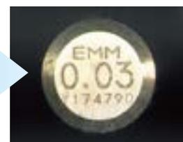
微細加工を切削で行うには、工具のチャッキング振れを抑えることは大変重要です。微細加工では、わずかなチャッキング振れが工具の損傷に繋がります。そこで、新しい表示方法として、シャンク端面へのマーキング方式を採用することでシャンク精度の向上を図っています。このことにより、真円度0.2μm以下、円筒度0.5μm以下のシャンク精度を保証しています。
