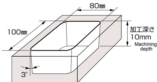
加工時間：24分 Milling time : 24 min
