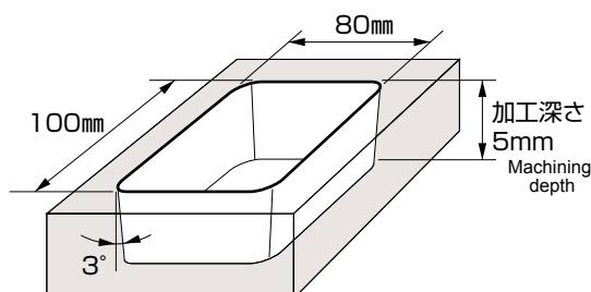
加工時間：33分 Milling time : 33 min
