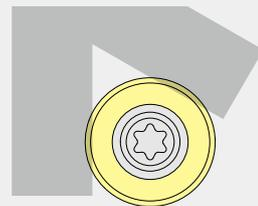
インサートおよびホルダーの拘束面は平面であり、各拘束面は鋭角でインサートをサポートするため確実な回転防止とインサート交換時の操作性が向上しています。
